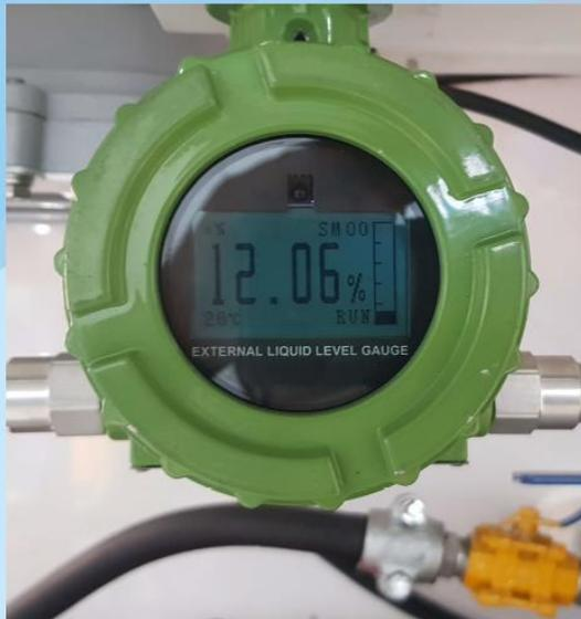
Medidor de nível não-intrusivo
