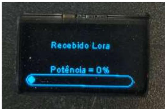
Figura 4.1.3. – Painel indicador do receptor ESP-32 com rádio LORA.
