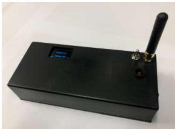
Figura 4.1.2. – Receptor ESP-32 utilizando rádio LORA.
