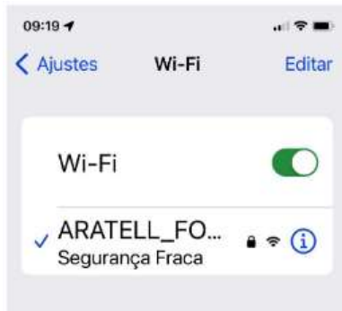
Figura 4.4.2 Rede Wifi, gerada pela CPU –ESP-32.
