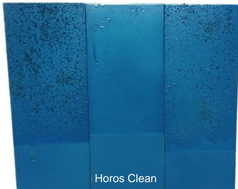
A gordura ou óleos são um dos tipos de impureza considerados bem críticos para o processo de pintura, devido as suas características químicas, elas repelem a tinta, e causam manchas, além disso, apenas com a água não é possível fazer a remoção total.
