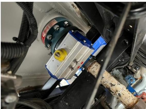
Foto vista de frente, ilustrando a válvula automatizada de redundância instalada logo abaixo da válvula de fundo
