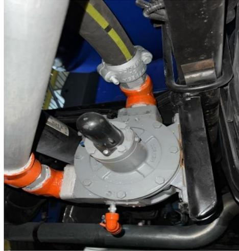
Bomba de 2", instalada em um suporte fixado na longarina dianteira do caminhão, lado direito (Esquema hidráulico redesenhado para instalação de uma válvula automatizada de redundância da válvula de fundo).
