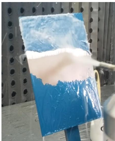
Figura 3 – Utilização de água para remoção do produto
