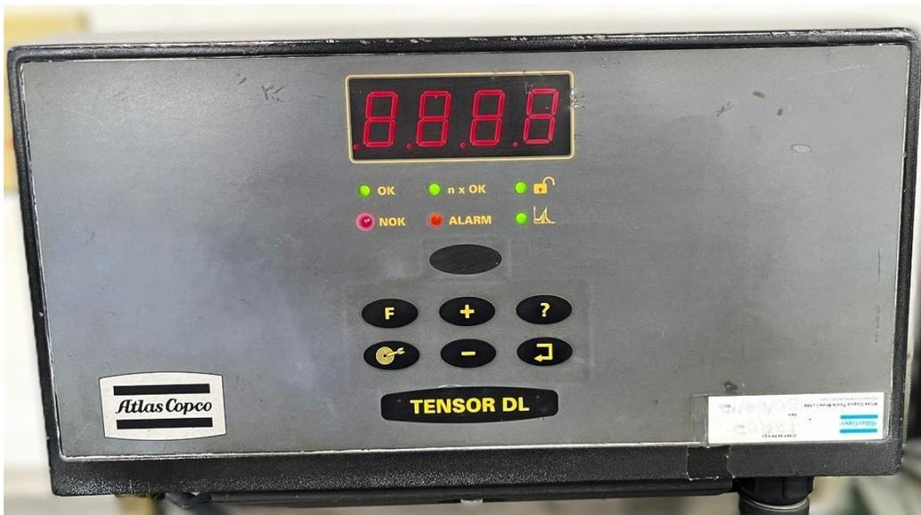
Figura 3: (frente do painel eletrônico e controlador de torque)
