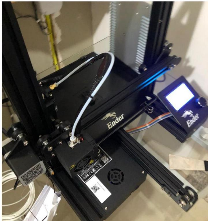
Figura 2 – Impressora 3D Ender / Modelo para filamento PLA e PETG
