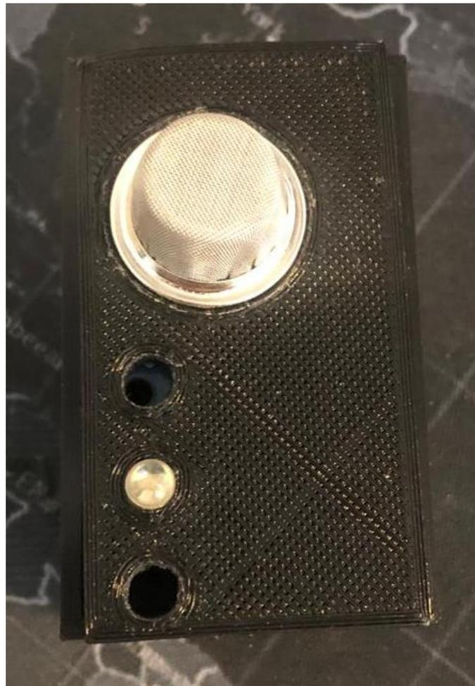
Figura 6 – Protótipo IoT versão 01 (40mm x 68mm)
