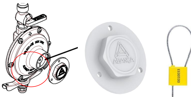
FIGURA 3 - SISTEMA DE LACRE COM A SOBRE-TAMPA DO REGULADOR
